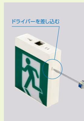
LEDモジュール、バッテリーの交換時は器具の横面にあるスリットヘッドライバーを差し込みブロックを外します。
